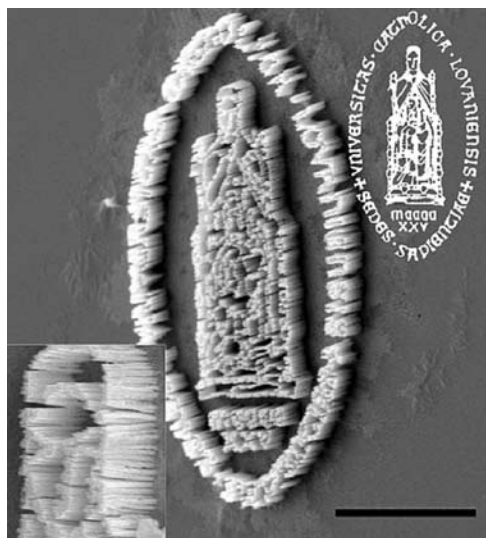
Figure 8 : le logo de l'UCL composé de nanofils, extrait de A. Vlad, M. Mátéfi-Tempfli, S. Faniel, V. Bayot, S. Melinte, L. Piroux et S. Mátéfi-Tempfli, « Controlled growth of single nanowires within a supported alumina template », Nanotechnology , vol. 17, 2006, p. 4873-4876, p. 4875.
